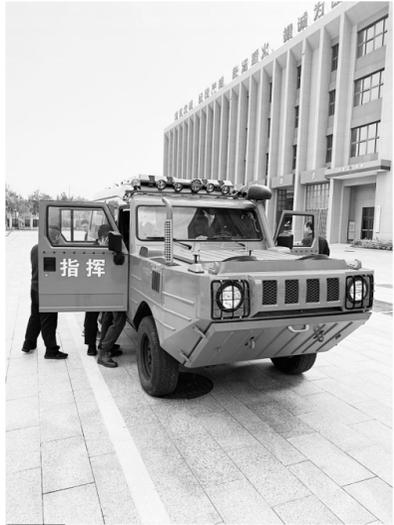
石狮采购的水陆两栖应急指挥车，陆地四轮驱动分时四驱，最高时速接近95公里；水中行驶螺旋桨驱动，最高时速超12公里
