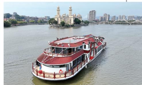
3月21日,“闽江会客厅”纯电动客船在闽江首航(无人机照片)。当日,福建首艘自主设计建造的纯电动大型高端客船“闽江会客厅”在闽江首航。全船长度38.48米,型宽10.1米,能够载客212人,满载时最大航速达20km/小时,在观光航速航行下,其续航力可达10小时。(新华)
