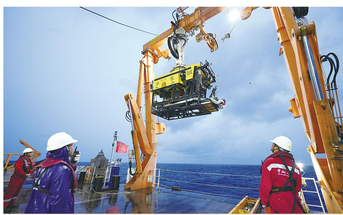
▲我国自主研制6000米级深海无人遥控潜水器“海琴”号成功海试 8月23日清晨拍摄的“海琴”号从海里回收时的情景。8月23日清晨,在南海的晨曦中,我国自主研制的6000米级深海无人遥控潜水器(ROV)“海琴”号,经过8个小时作业,从4140米深海凯旋,成功进行海试,我国深海研究又多了一个“科考利器”。“海琴”号由上海交通大学水下工程研究所自主研制,是为“中山大学”号海洋综合科考实习船量身定制的新型高效深海电动ROV系统,搭载了高清摄像机、多功能机械手、探测传感器等科考设备,具备自动定向、悬停定位、自动巡航等智能作业能力。(新华社)
