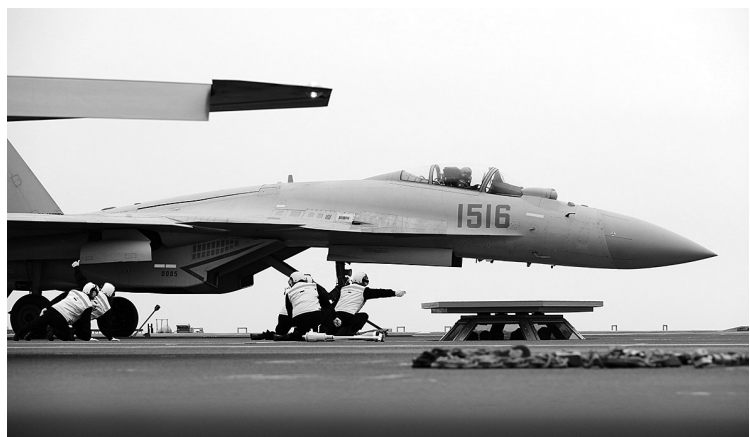
歼-15T舰载战斗机在福建舰上电磁弹射起飞，起飞助理做出放飞手势
