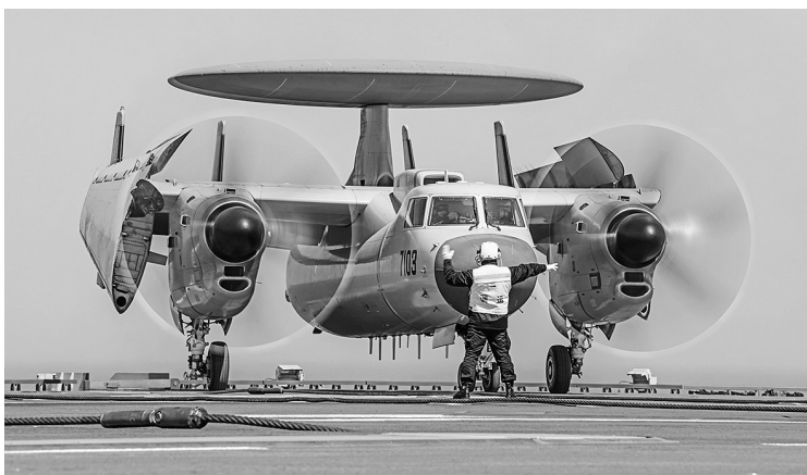
福建舰航空保障人员引导空警-600舰载预警机飞行员展开机翼
