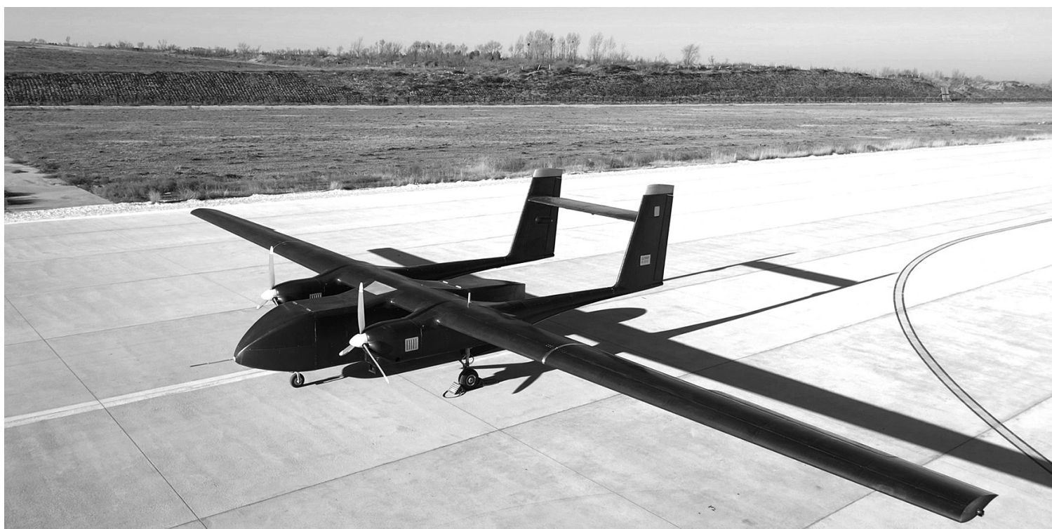
▲“天马-1000”无人运输机成功首飞 1月11日，由中国兵器工业集团西安爱生技术集团有限公司自主研发的“天马-1000”无人运输机顺利完成首次飞行试验，各项飞行数据表现良好，首飞取得圆满成功。“天马-1000”集物流运输、应急救援、物资投送等多功能于一体，好比空中“货拉拉”，是国内首款实现“高原复杂地形适配、超短距起降、货运/空投双模快速切换”的中空低成本运输平台。其升限达8000米，滑跑起降距离小于200米，最大航程1800公里，最大载重1吨。这一机型还可通过模块化货舱快速切换，灵活转换为物资投送平台，适应多样化任务需求。（新华）
