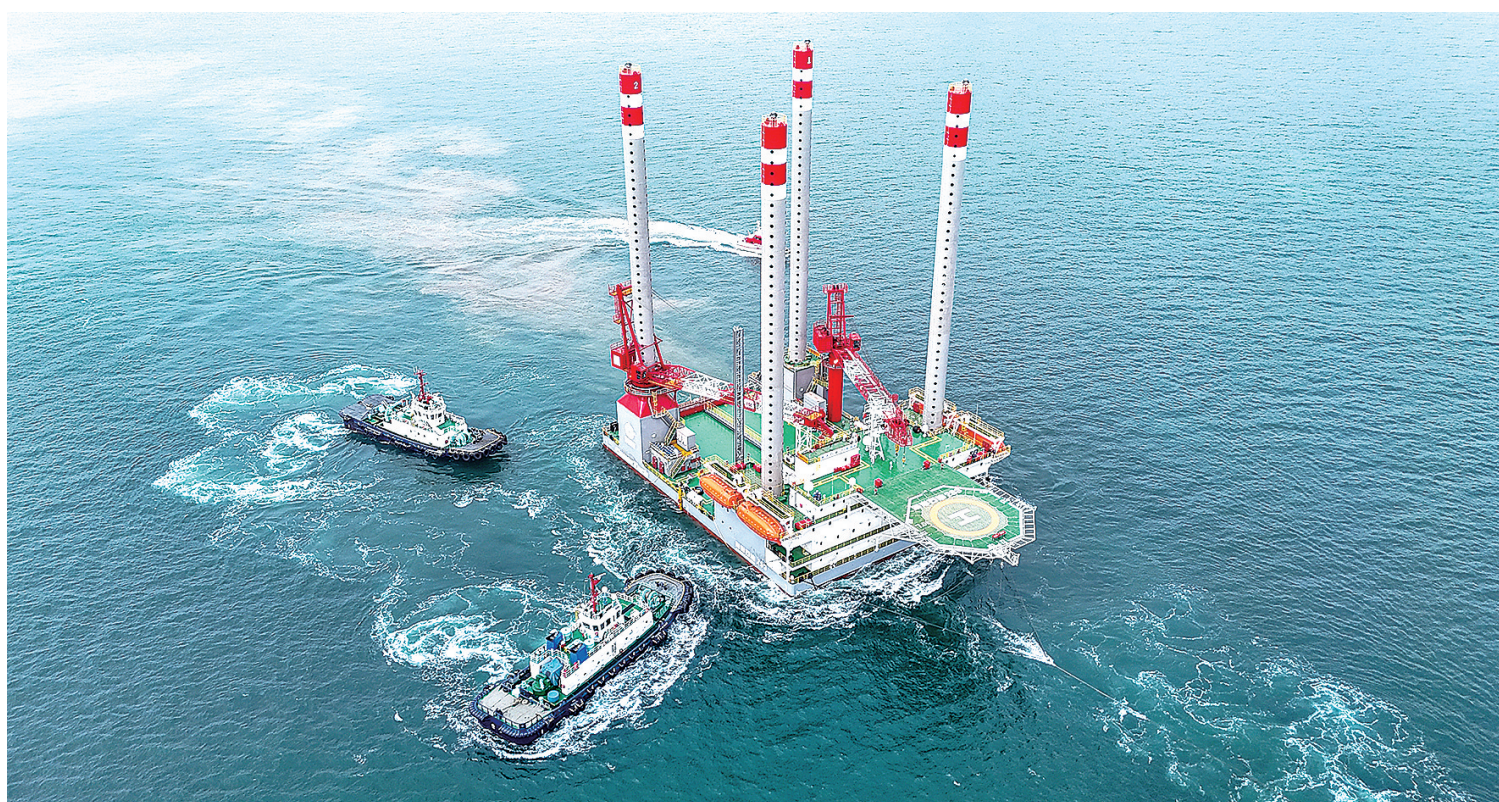
▲我国首座海上移动式多功能措施平台启运渤海油田 5月14日，我国首座海上移动式多功能措施平台“海洋石油283”从青岛西海岸新区启运（无人机照片）。当日，我国首座海上移动式多功能措施平台“海洋石油283”（又称“增产一号”）从青岛西海岸新区启运，发往渤海油田。该平台采用“移动式+模块化”设计，总重7300余吨，最大作业水深40米，集酸化、压裂、调驱、调剖、稠油热采等功能于一体，并引入AI智能监测，投用后将有效支撑渤海油田增储上产。（新华）
